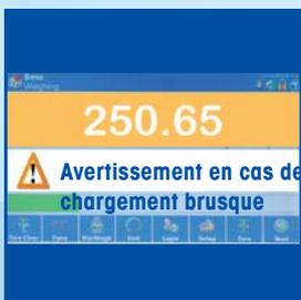
Le système POWERCELL contrôle les événements de chaque cellule de pesage tels que les surcharges, les chargements brusques et la dérive du zéro. Cette approche assure la visibilité sur l'état du système et permet d'intervenir avant tout arrêt ou mesure incorrecte.
